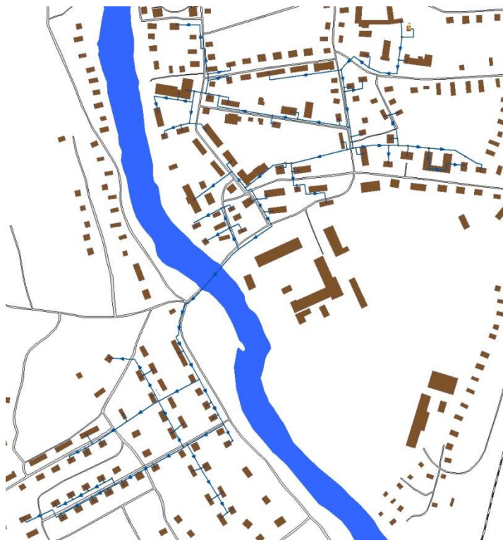
Рис.2.3 Тепловая сеть БМК в п. Шалакуша
