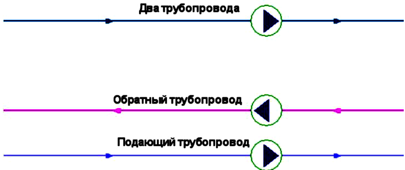
Рис.4.6 Сверху: однолинейное изображение, снизу – внутреннее представление
