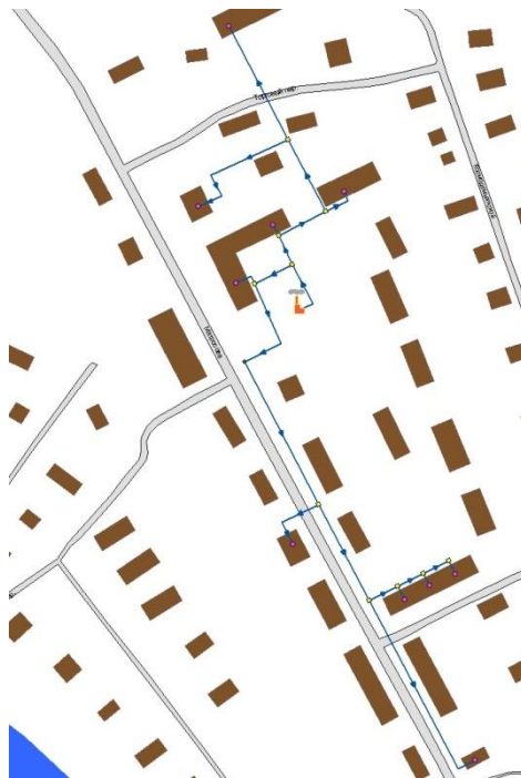
Рис. 2.5 Схема тепловых сетей котельной №2 п. Шалакуша
